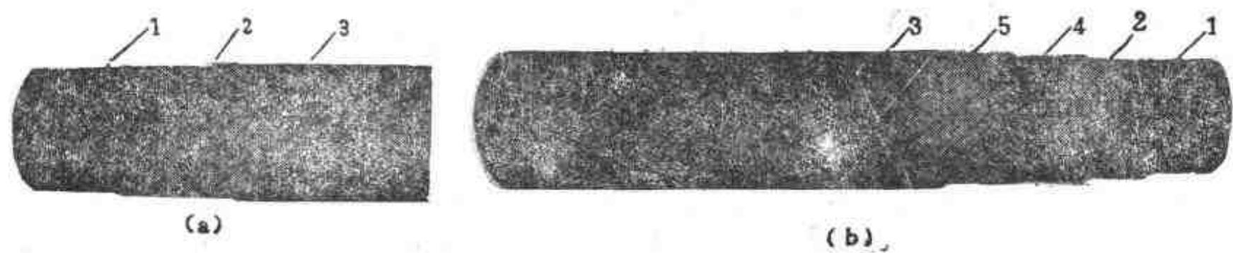
图 2-2-4 纤维编织胶管结构 (a)单层编织；(b)多层编织 1—内胶层；2、5—纤维编织层；3—外胶层；4—中胶层
