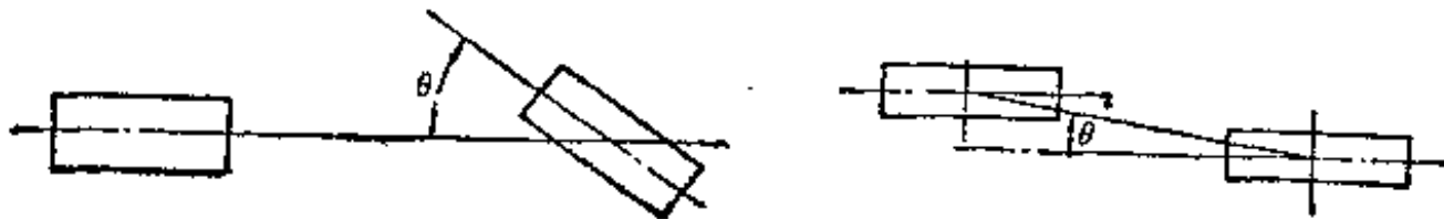
图 1-5-24 带轮轴线夹角 \theta
