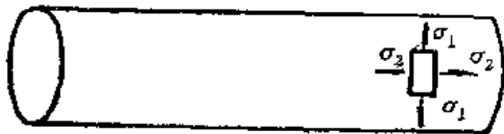
图 2-5-1 胶管受力状态示意图 \sigma_1 —周向应力; \sigma_2 —轴向应力
