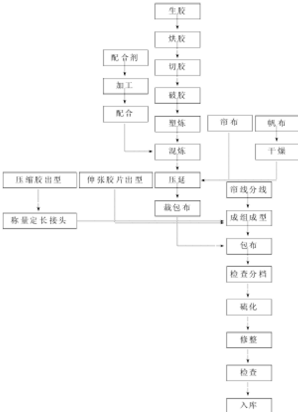
图 3-2 普通 V 带生产工艺流程
