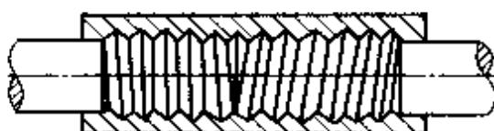
图 6-17 螺纹式冷压接头断面示意
