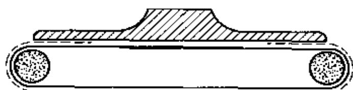
图 6-24 双鼓式包叠成型断面示意
